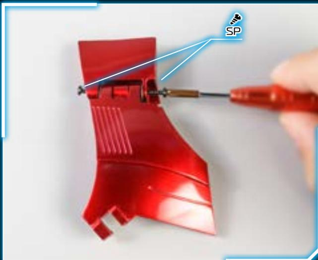
3 - Добавьте к собранной конструкции заднюю пластину правого плеча (83А), присоединив ее так, как показано на фотографии. Закрутите по одному винту SP с каждой стороны петли.
