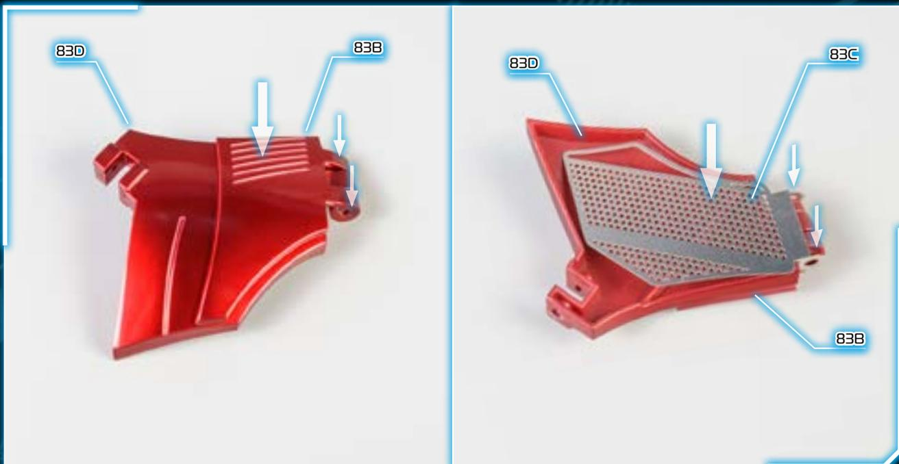
2 - Поместите правый верхний щиток (83В) поверх щитка (83D) так, чтобы отверстия их петель совпали. Переверните обе детали и установите стабилизатор (83С) так, чтобы отверстия его круглых отогнутых частей совпали с отверстиями петель детали (83В).
